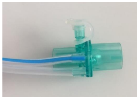
Obrázek 5.8: Senzor iFlow 40 S. Fotografie: autor.
