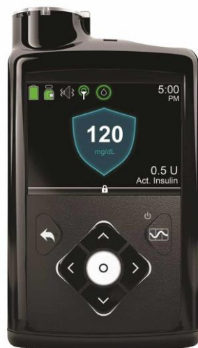
Obrázek 2.8: Inzulínová pumpa MiniMed 670G Systém, signalizující aktuální koncentraci glukózy a množství aplikovaného inzulínu inzulínového pera v jednotkách inzulínu za hodinu. Fotografie: [33]
