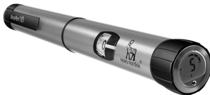
Obrázek 2.7: Ukázka inzulínového pera NovoPen ECHO s nastavitelným množstvím podávaného inzulínu a displejem s historií podaného inzulínu. Fotografie: [28]
