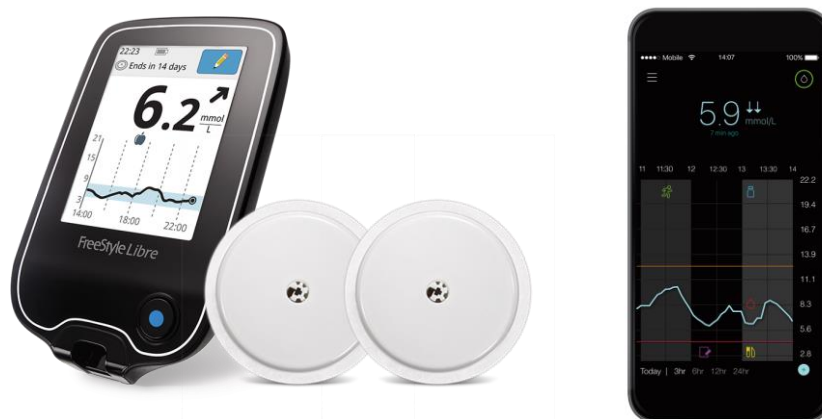
Obrázek 2.6: Modifikované systémy CGM. FGM Abbott FreeStyle Libre. (vlevo) a Smartphone jako přijímač CGM systému Medtronic Guardian Connect (vpravo).
