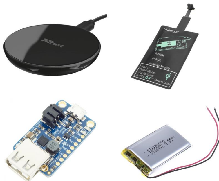
Obrázek 4.5: Přehled komponent vybraných pro sestavení bezdrátového nabíjení. Shora zleva: platforma bezdrátového nabíjení, cívka pro bezdrátové nabíjení, napět'ový měnič a lithium iontová baterie. Fotografie: [41, 42, 43, 44]
