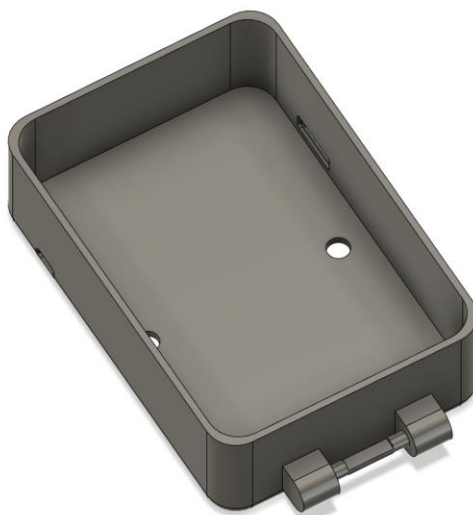
Obrázek 4.16: Krabička uvnitř (prázdná) (Fusion360)
