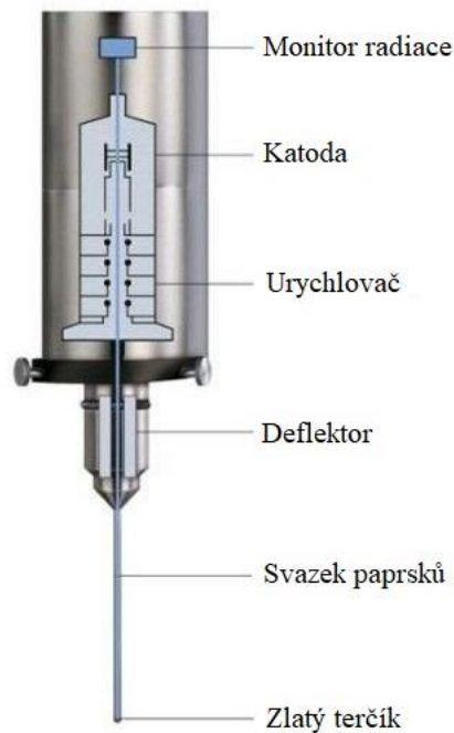
Obrázek 2.5: Schéma zdroje rentgenového záření [38]
