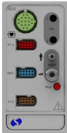
Obrázek 7.1: Zobrazení modulu SpaceLabs 91496. Analogový výstup je označen jako HLO – High Level Output. Převzato z [36].
