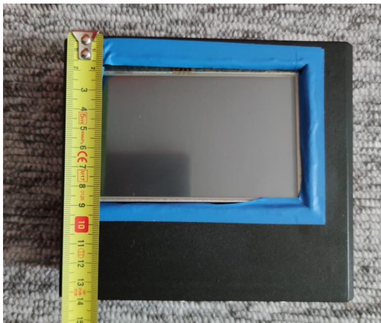
Obrázek 1: Rozměry přední strany mobilní jednotky obsahující displej. Metr je přiložen pro reálnější představu rozměrů mobilní jednotky.
