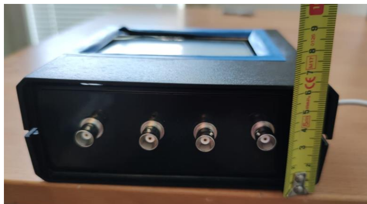
Obrázek 5.10: Boční část s koaxiálními konektory pro propojení mobilní jednotky s měřicími přístroji.
