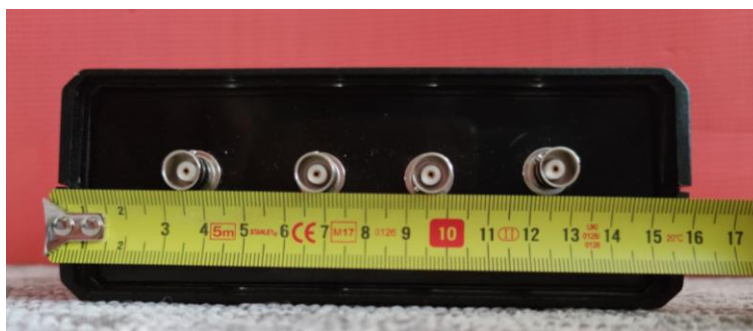
Obrázek 2: Rozměry šířky strany obsahující redukci pro koaxiální kabel. Metr je přiložen pro reálnější představu rozměrů mobilní jednotky.
