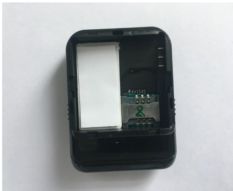
Obrázek 5. GPS s GSM vzdáleným odposlechem (pohled na slot pro SIM kartu).
