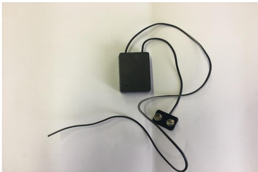
Obrázek 1. FM vysílač (s anténou a napájecím konektorem na 9 V baterii).
