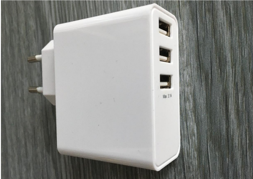
Obrázek 8. Odposlech integrovaný v nabíječce. Získané údaje odesílá prostřednictvím Wi-Fi signálu.
