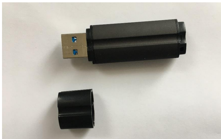
Obrázek 9. Funkční flash disk se záznamníkem zvuku (umožňuje cca 50 hod záznamu).
