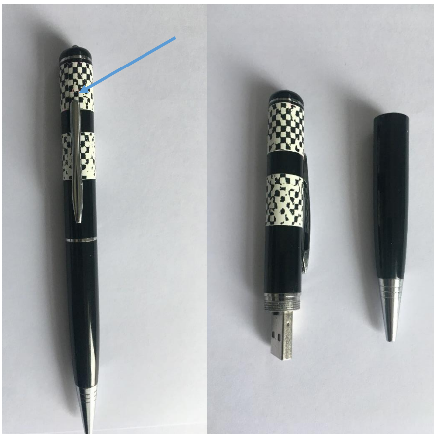
Obrázek 10. Minikamera se záznamníkem ukrytá ve funkčním peru (objektiv kamery se nachází v černém čtverečku nad sponou).
