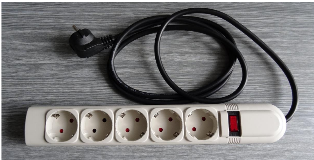
Obrázek 6. Funkční zásuvková lišta se zabudovaným GSM modulem.
