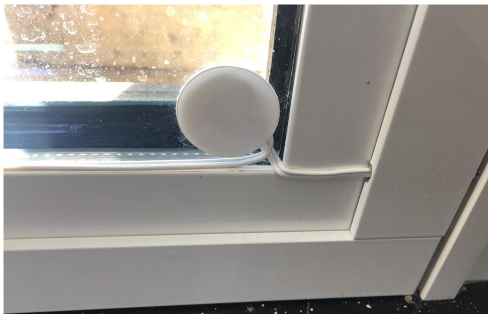
Obrázek 22. Piezo měnič přilepený na sklo (k přenesení vibrací do skleněné tabule okna).
