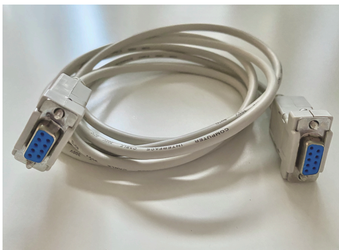
Obrázek 4.2: Použitý sériový laplink firmy PremiumCord. Fotografie: autor
