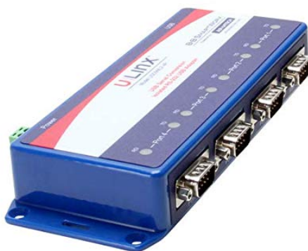
Obrázek 4.5: Převodník RS-232 do USB [18].
