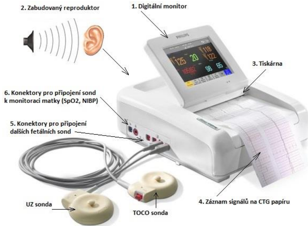
Obr. 2.5: Konstrukce CTG monitoru a připojení sond. Úprava autora. [19]
