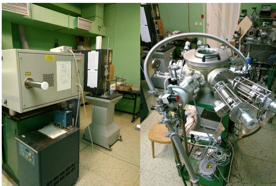
Obr. 3.3.1.1: Dva lasery využívané pro duální PLD (vlevo), vakuová komora (vpravo). Fotografie: vlastní
