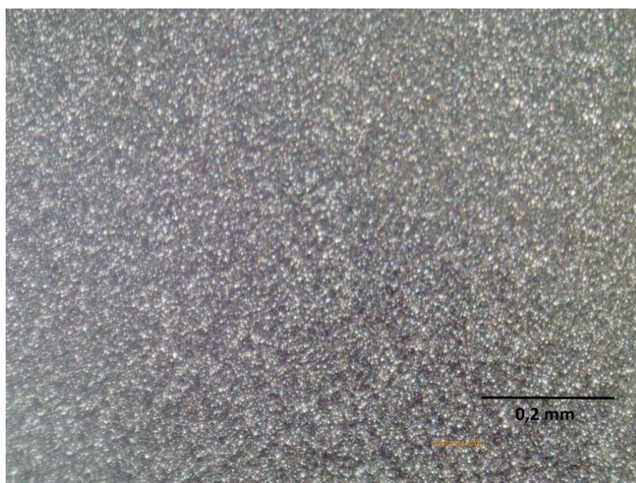
Obr. 4.1.2.3: Optický mikroskop přiblížení – vrstva germania ( \text{Ge } 2 - 2 \text{ J/cm}^2 )
