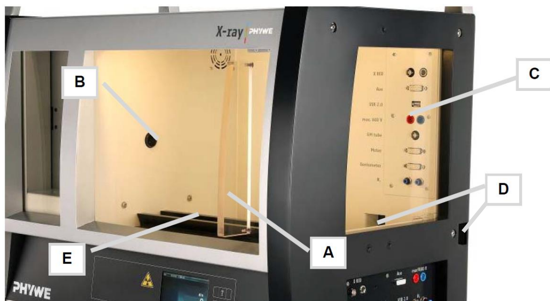
Obr. 2.3: Experimentální prostor zařízení. A – posuvná dvířka, B – otvor pro výstup RTG záření, C – vnitřní propojovací panel v experimentálním prostoru, D – přístupový kanál. [41]
