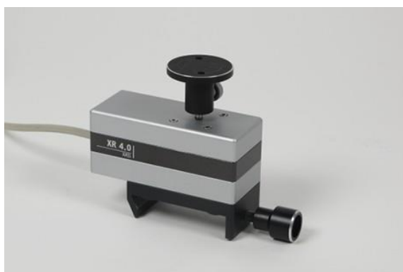
Obr. 2.8: Otočný stolek pro umístění vzorku poháněný krokovým motorem. [45]
