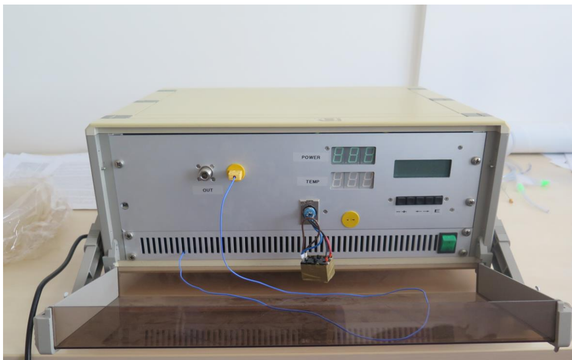
Obrázek 20: Výkonový generátor pracující na frekvenci 2.45 GHz
