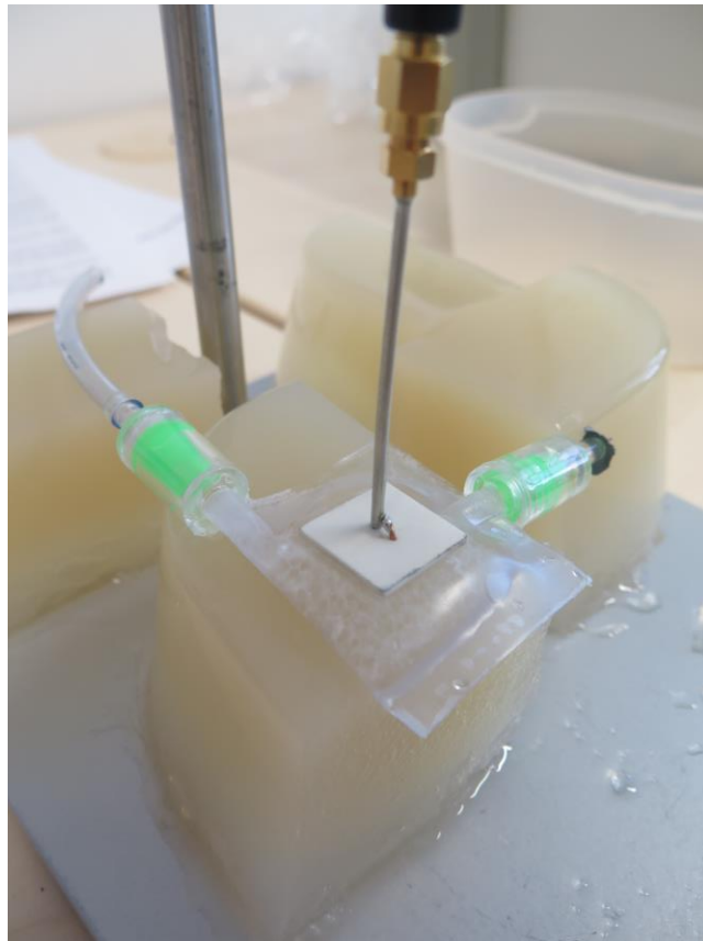
Obrázek 49: Detailní ukázka lokálního mikrovlnného ohřevu na agarovém fantomu s vodním bolusem
