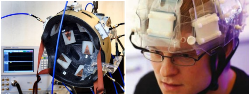
Obrázek 11: Vlevo 1. generace, vpravo 2. generace MWI systému z technické univerzity v Göteborgu, převzato z [47]
