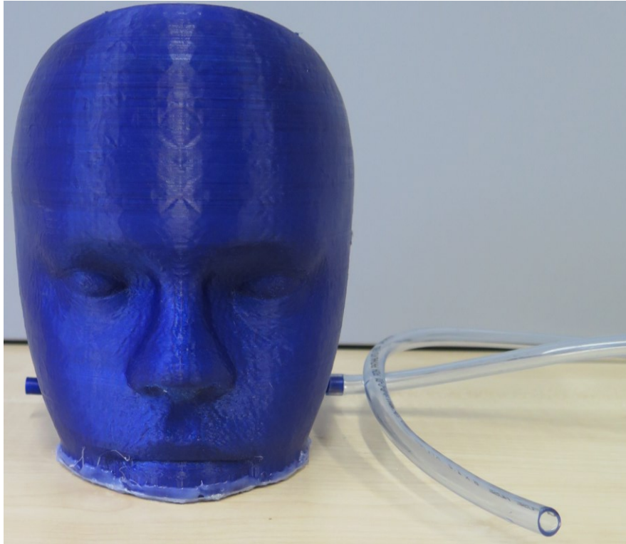
Obrázek 41: Vyrobený fantom lidské hlavy s hadicí k napouštění a vypouštění fantomu lidského mozku
