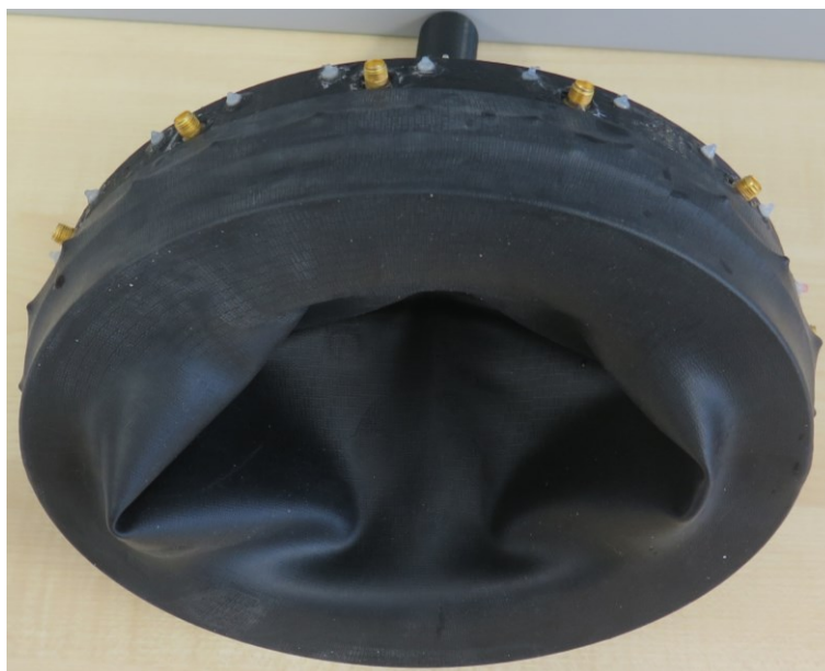
Obrázek 43: MWI systém s řešením kontaktu mezi anténami a fantomem lidské hlavy
