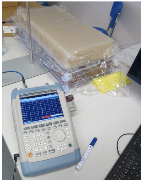
Obrázek 2.14: Měření koeficientu odrazu s agarovým fantomem.
