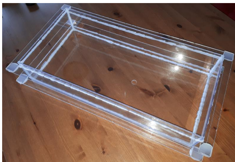
Obrázek 2.10: Vytvořený box pro patch anténu tvořící zároveň vodní bolus.
