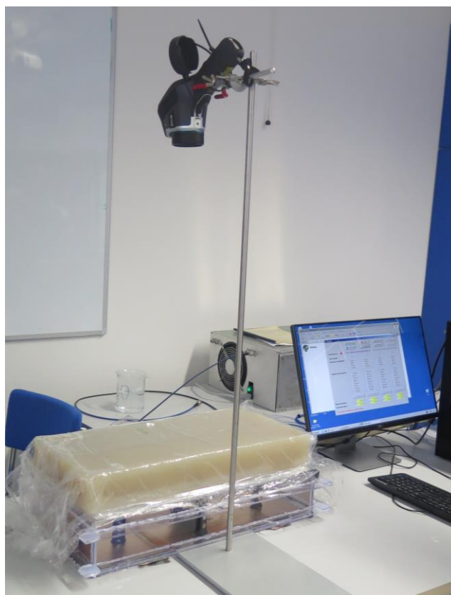
Obrázek 2.15: Aplikace mikrovlnného záření a aparatura pro snímání teploty.
