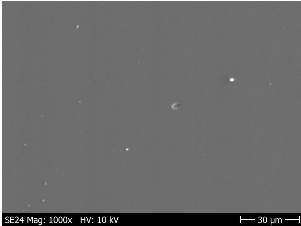
Obrázek 3.8: SEM vzorku 24 – 0,7% at.% Ca
