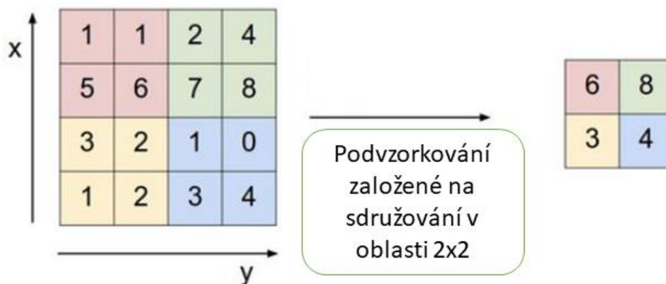
Obrázek 2.4: Schéma principu podvzorkování sdužováním maxima v oblasti 2x2 prováděného v konvoluční vrstvě. Zdroj: [29]
