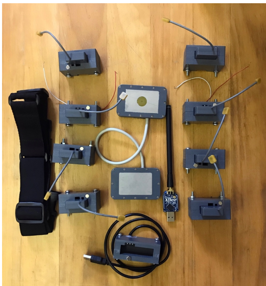
Obrázek 7 Fotografie systému FlexiGuard použita při experimentech v praktické části diplomové práce. Nahoře zleva: popruh pro uchycení hlavního senzoru a řídicí jednotky, 4 BAN nody v dokovacích stanicích, hlavní senzor a řídicí jednotka spojené kabelem, USB přijímač s anténou a 4 BAN nody v dokovacích stanicích. Dole: dokovací stanice pro řídicí jednotku. Vlastní tvorba.
