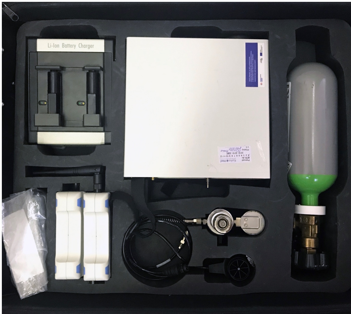
Obrázek 2 Fotografie zařízení systému OxyconMobile, které je uloženo v kufru. Nahoře zleva: nabíječka baterií a baterie, přijímací jednotka a tlaková bomba pro kalibraci zařízení. Dole zleva: jednotka SBx, jednotka DEx s anténou, ventil na tlakovou bombu a tripleV senzor. Vlastní tvorba.
