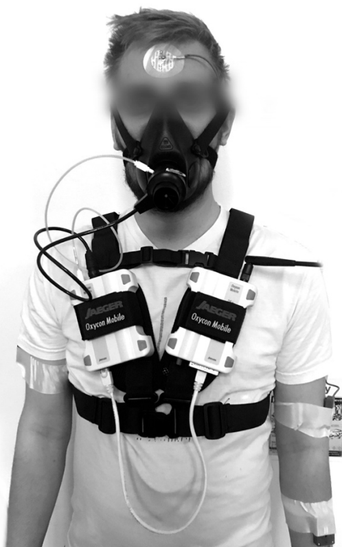
Obrázek 10 Fotografie jednoho z probandů se zkalibrovaným a nainstalovaným systémem OxyconMobile. Na hrudníku je umístěna vlevo jednotka SBx pro analýzu plynů a vpravo DEx s anténou, baterií a paměťovou kartou. Na obličeji je umístěna lícnice masky pomocí popruhů velikosti L. Do lícnice je vložen TripleV senzor. Pohled z přední strany. Vlastní tvorba.
