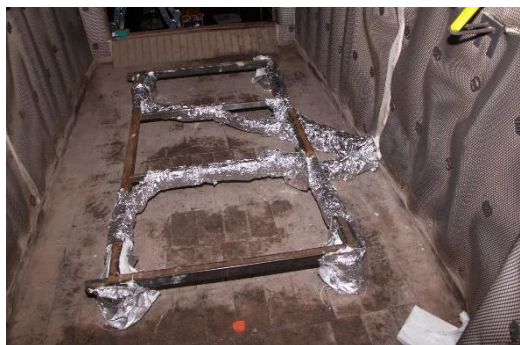
Obrázek 40 - Instalace tenzní váhy v prostoru pece [zdroj autor].
