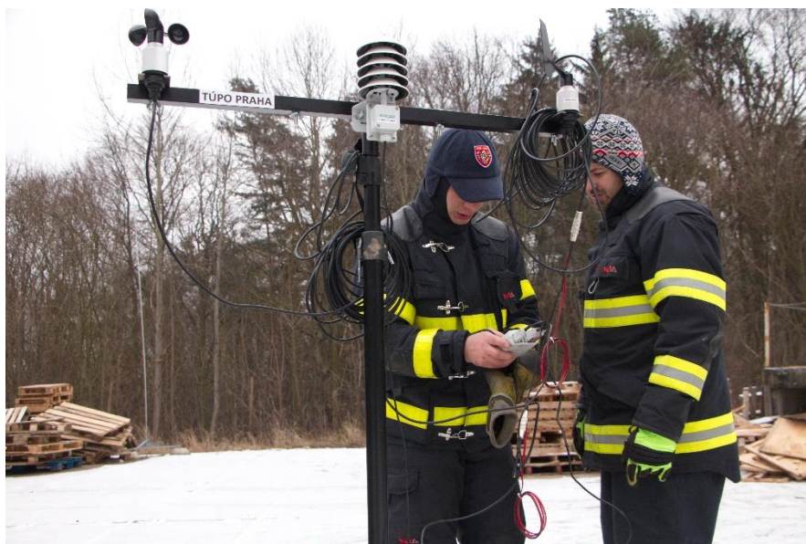
Obrázek 38 – Instalace meteorologické stanice Almemo [zdroj autor].
