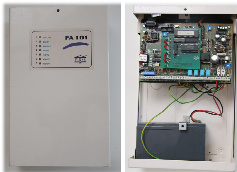
Obrázek 7 Objektové zařízení FA101a. Zdroj: vlastní
