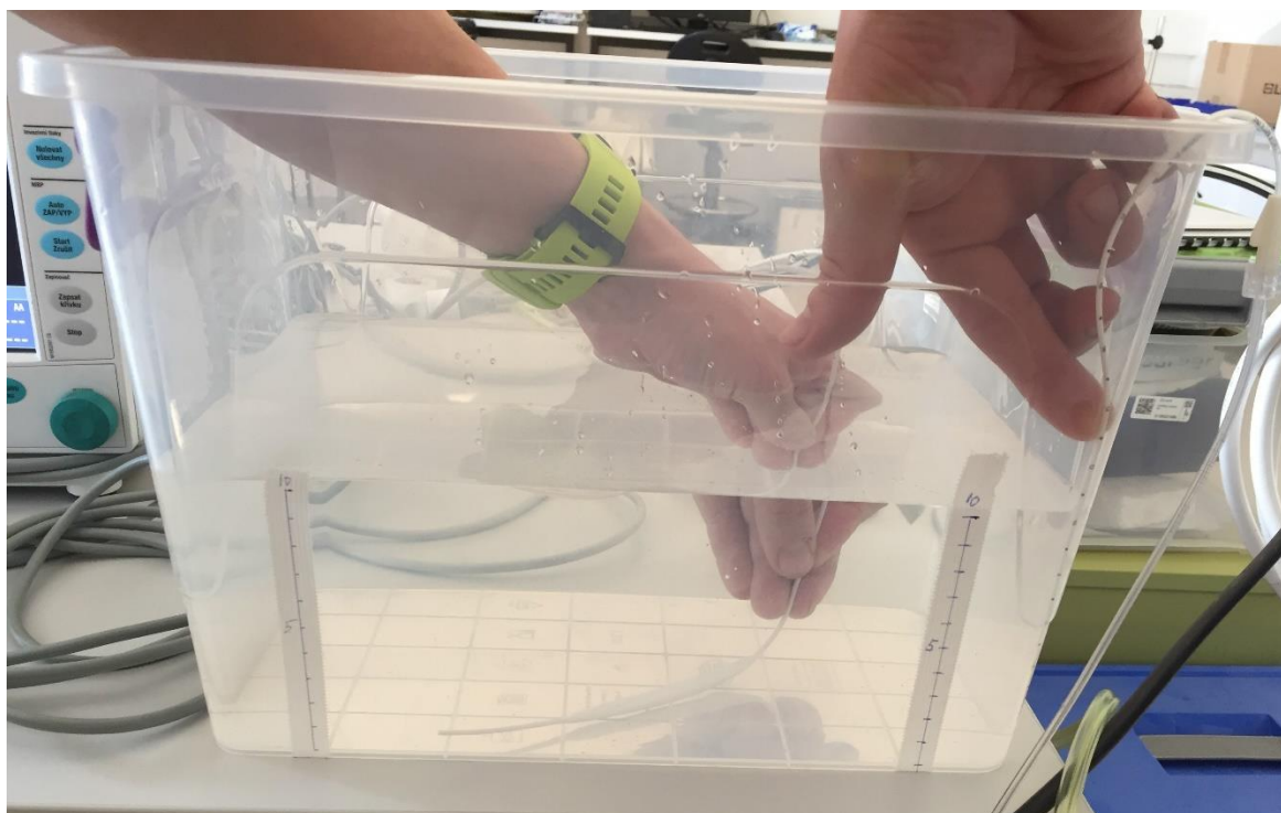
Obrázek 5: Kalibrace katetrů stejným přtlakem
