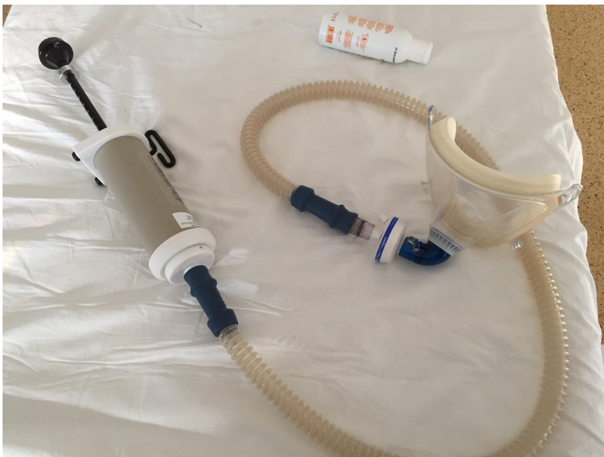
Obrázek 3: dýchací okruh pro kalibraci EIT
