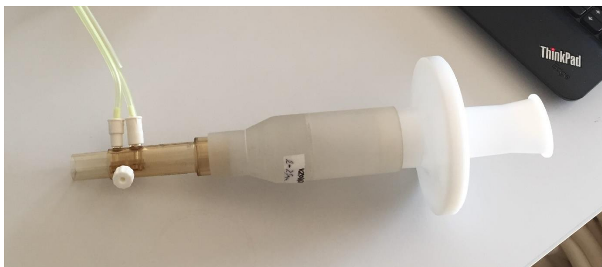
Obrázek 4: D-Lite senzor s náustkem použitý při HFNC fázi
