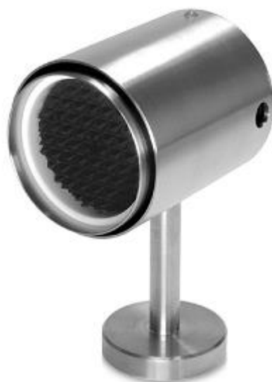
Obr. 2.10: Ukázka modelu kalibračního tělesa používaného ke kalibraci IR kamery [26]
