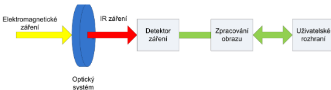
Obr. 2.4: Ukázka přenosu záření z objektu do výsledného obrazu, [16]
