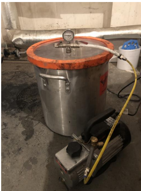
Obr. 2.3: Vakuovací nádoba s vývěvou.
