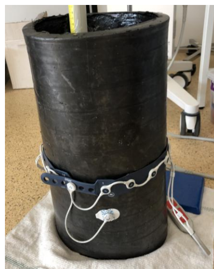
Obr. 3.4: a) Ukázka dostatečného kontaktu elektrod. b) Kompletní fantom s nasazeným elektrodovým pásem.
