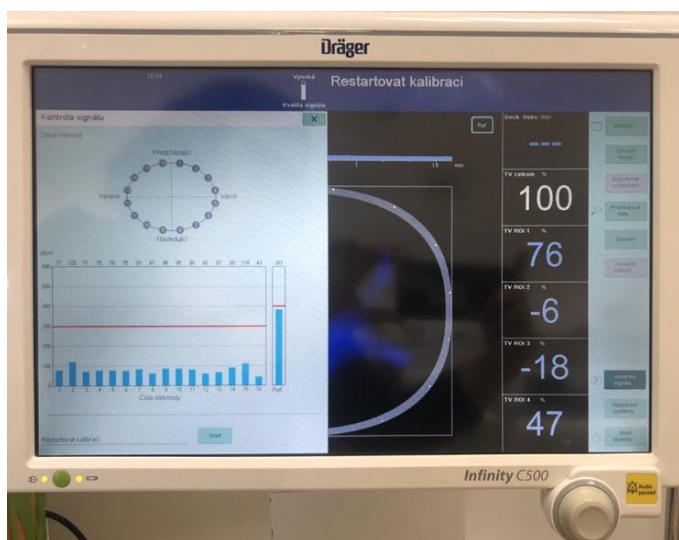
Obr. 3.4: a) Ukázka dostatečného kontaktu elektrod. b) Kompletní fantom s nasazeným elektrodovým pásem.
