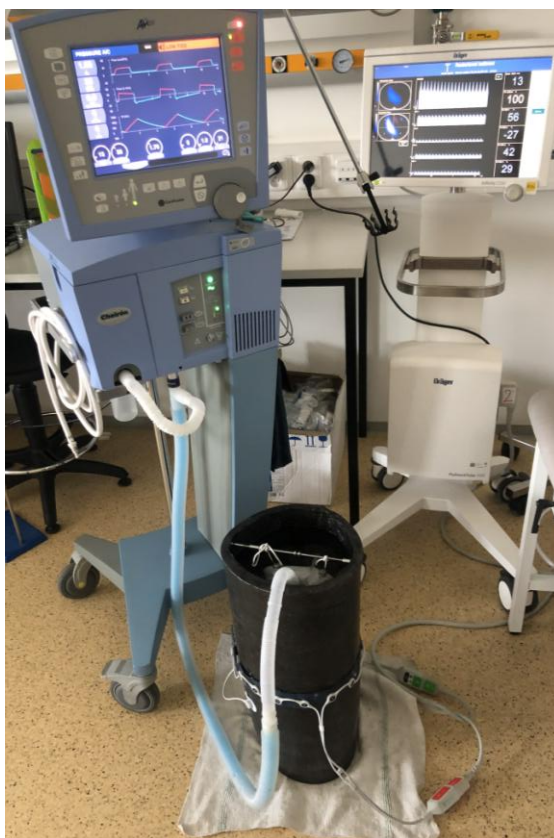
Obr. 3.7: Znáornění průběhu experimentu zjišťující vliv aplikace elektrodového gelu na výsledný obraz rozložení bioimpedance v tomografické rovině hrudníku.
