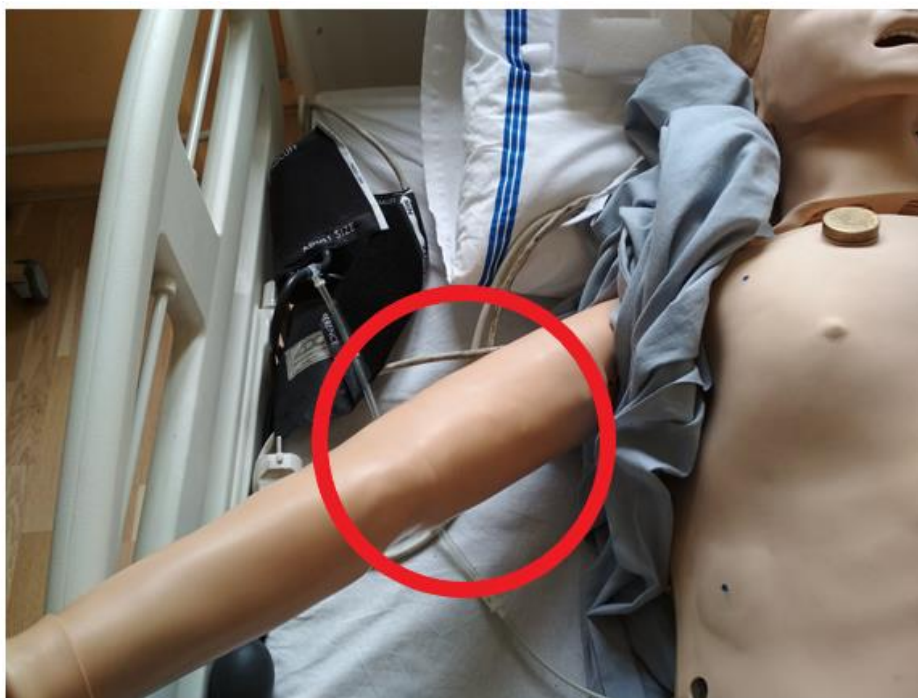
Obrázek 4.7: Aktuátor zakrytý umělou kůží
