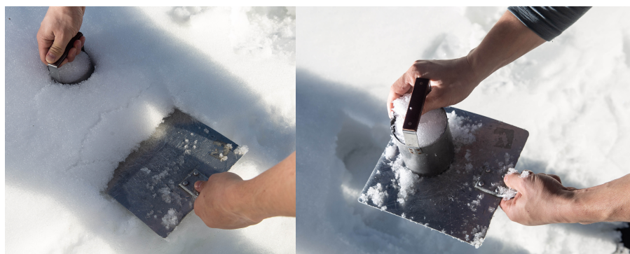
Obr. 2.15: 300ml kovové vykrajovátko s podložkou pro měření hustoty sněhu. Fotografie: Michal Fanta
