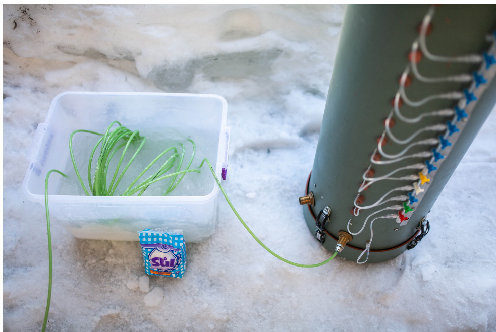
Obr. 2.12: Chlazení směsi plynů před vstupní komorou. Fotografie: Michal Fanta
