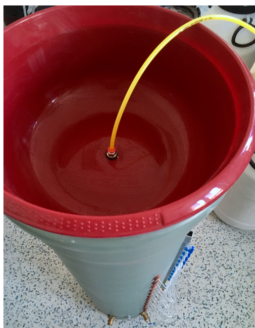
Obr. 2.10: Plastové víko s průchodkou pro přívod vzduchu.
