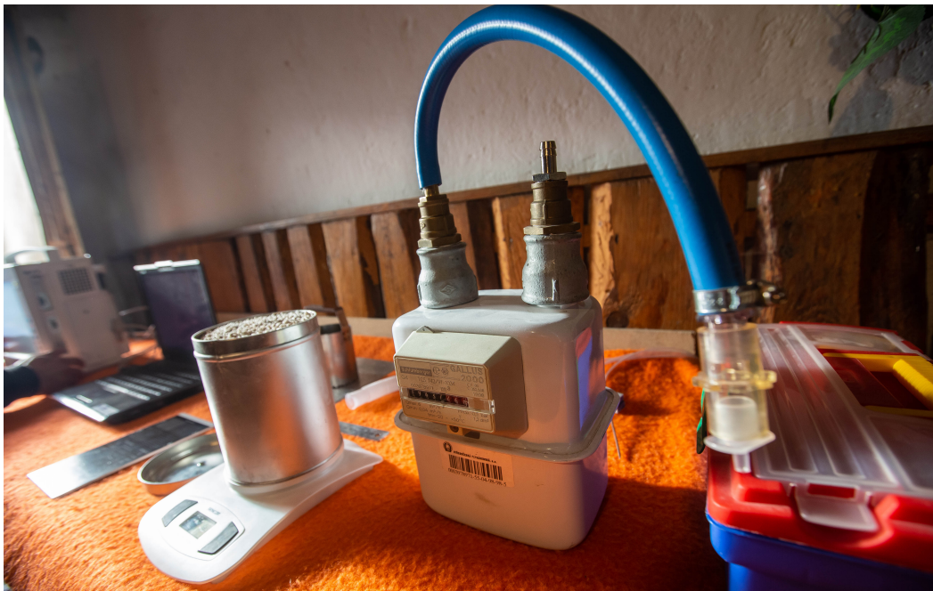
Obr. 2.14: Rigidní nádoba s váhami pro měření hustoty perlitu a plynoměr pro měření průtoku. Fotografie: Michal Fanta
