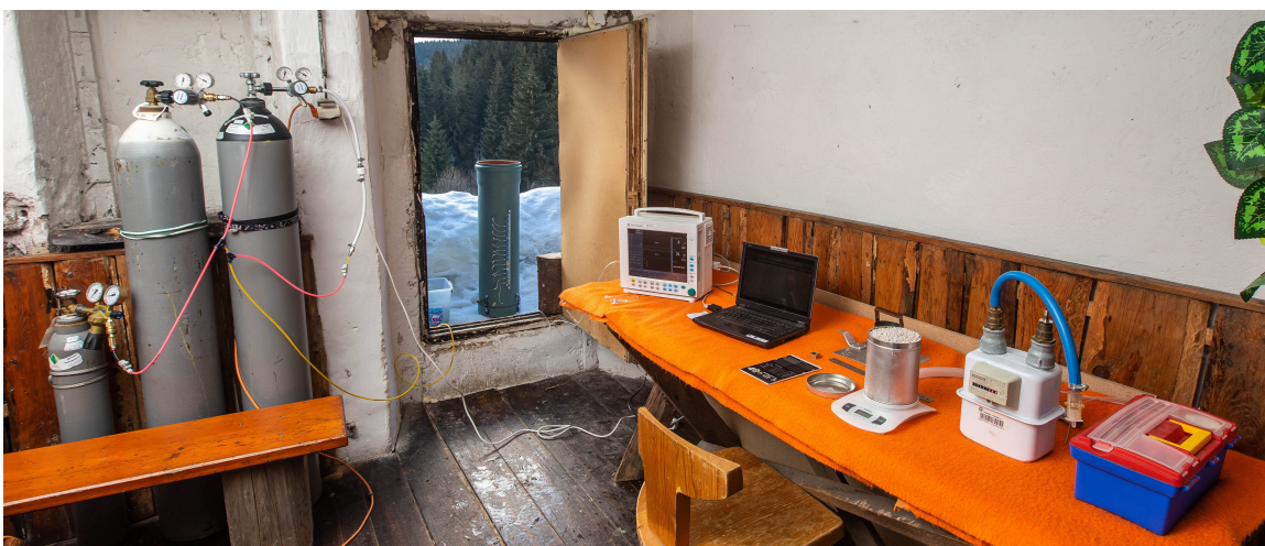
Obr. 2.7: Terénní laboratoř pro měření difuzních a konvekčních vlastností respiračních plynů ve sněhu. Fotografie: Michal Fanta
