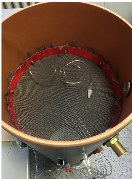
Obr. 2.4: Síťka oddělující potrubí na část pro materiál a část pro proudění plynů.
