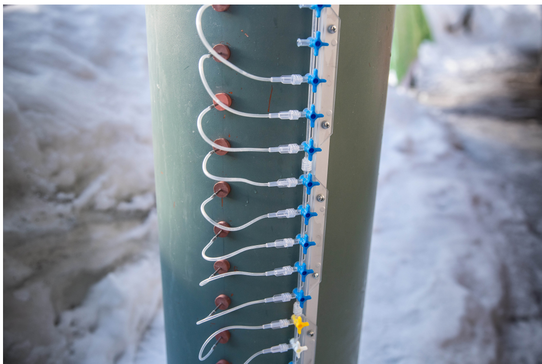
Obr. 2.5: Hliníková lišta se sadou trojcestných ventilů, hadiček a infuzních jehel. Fotografie: Michal Fanta
