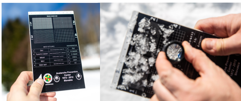
Obr. 2.16: Rastr s lupou pro určení typu sněhu a velikosti zrn. Fotografie: Michal Fanta
