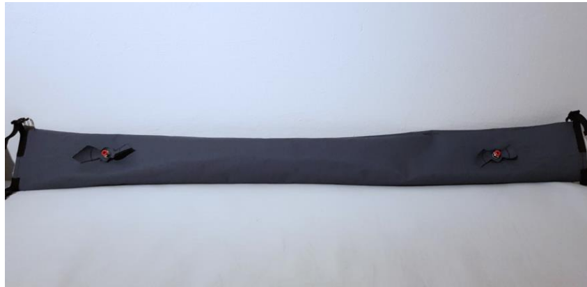
Obrázek 16: Vnější část vaku, se zavedenou vnitřní částí a vyvedenými fitinkami.
