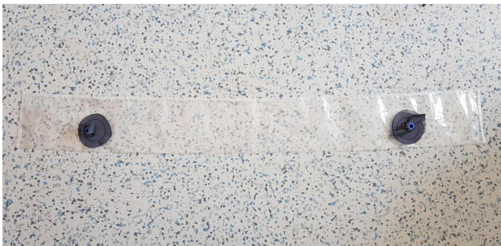
Obrázek 6: Vnitřní část vaku se zavedenými napojovacími fitinkami.
