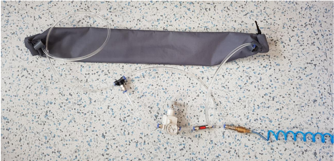
Obrázek 19: Zapojení pro zkoušku pevnosti vnější části se zavedenou vnitřní částí.
