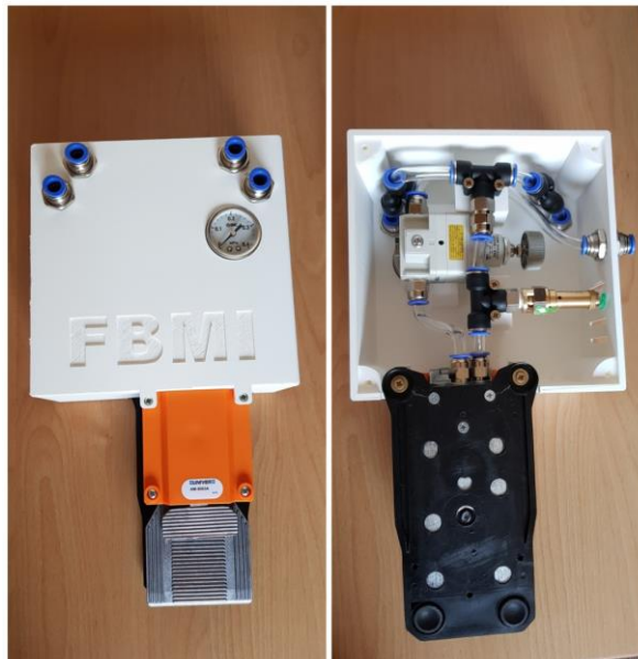
Obrázek 24: Vnější kryt a vnitřní uspořádání pneumatického obvodu.
