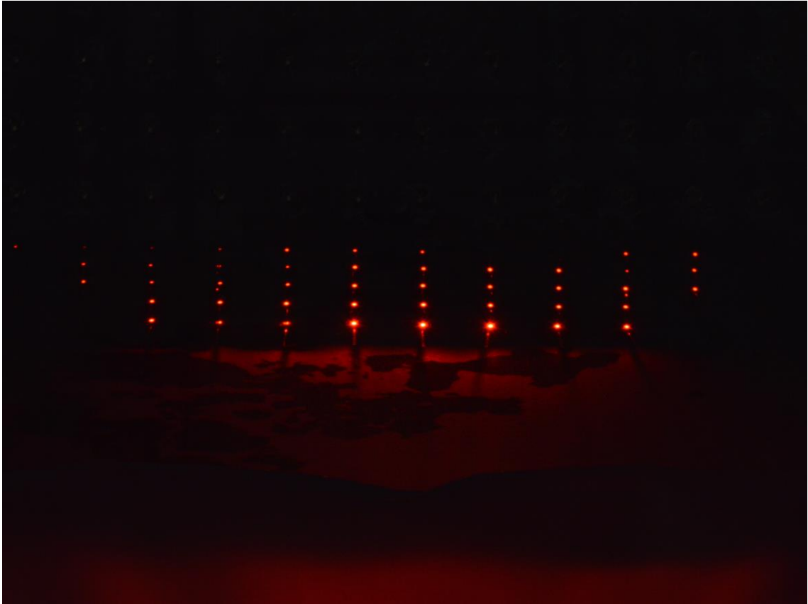
Obrázek 3.16 Matice se stejnými LED umístěná do středu působení elektromagnetického pole nad anténu
