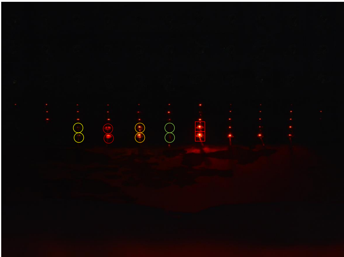
Obrázek 3.15 Matice s různými LED umístěná do středu působení elektromagnetického pole nad anténu
