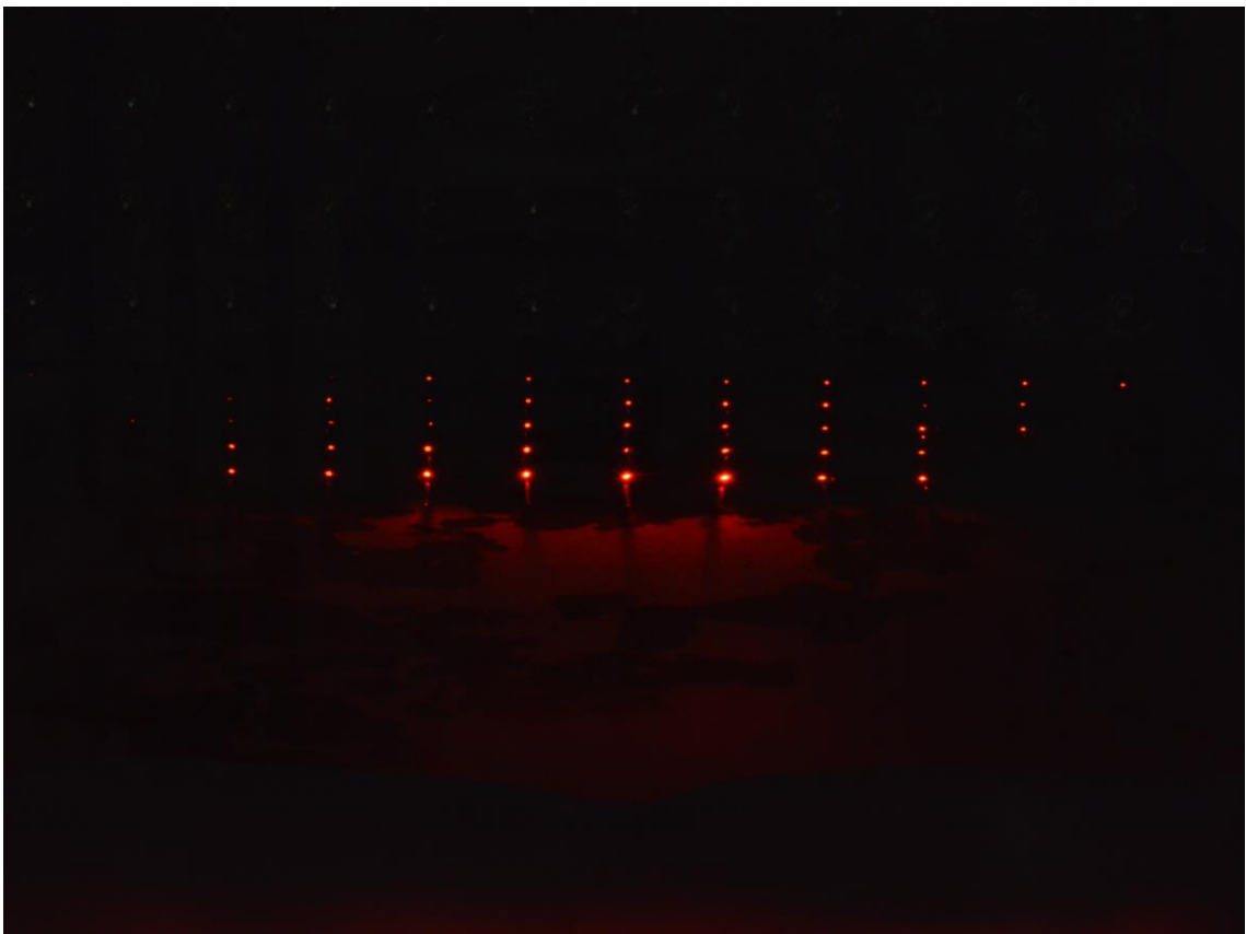
Obrázek 3.17 Matice se stejnými LED umístěná 5 cm od středu po ose působení elektrické složky pole
