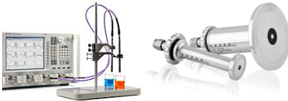
Obrázek 1: Sondy využívající otevřený konec koaxiálního vedení k měření dielektrických parametrů tkání. Vlevo úzká sonda značky Keysight; převzato z [16]. Vpravo robustní kovové sondy DAK Speag; převzato z [17].
