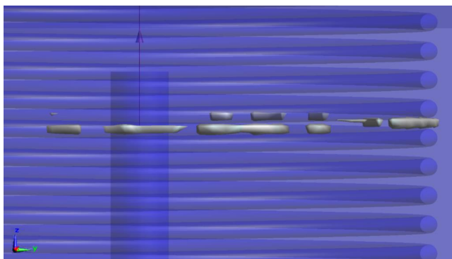
Obr. 3.15: Maximální hodnoty SAR při simulaci s protézou pro esofagus umístěnou paralelně vektoru polarizace elektrického pole.
