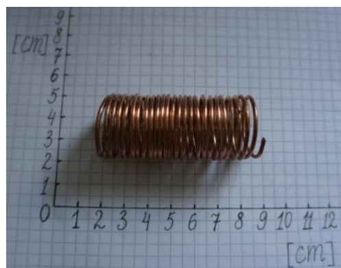
Obr. 2.14: Vytvořená model stentu pro jícen.
