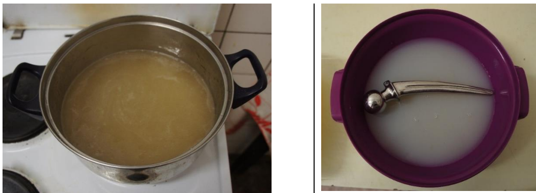
Obr. 2.16: Postup přípravy agarových fantomů.
