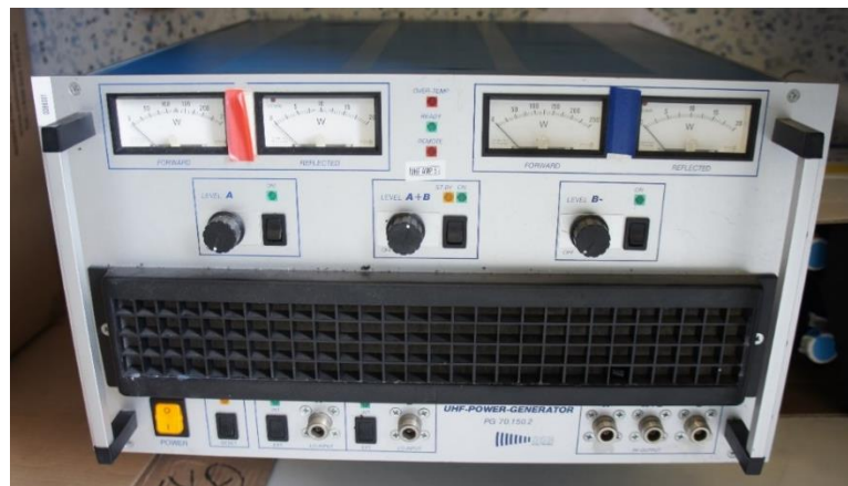
Obr. 2.10: Vysokovýkonný UHF generátor PG 70.150.2
