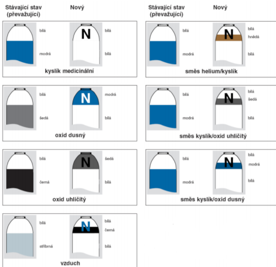
Obrázek 1.3 Správné barevné značení tlakových lahví, převzato z [11]
