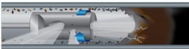
Obr. 20 Princip čištění tekutým dusíkem a ukázka čištění výměníku tímto zařízením [52].
