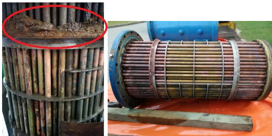
Obr.39 Vlevo je detail rozpuštěné koroze demontovaného chladiče z kompresoru po jeho vyčištění kvůli vizuální kontrole a obrázek vpravo je očištěný chladič před jeho montáží [9A].
