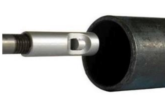
Obr. 13 Ukázka principu lehkého tryskání pro čištění vnitřního povrchu od firmy GAMIN [42].
