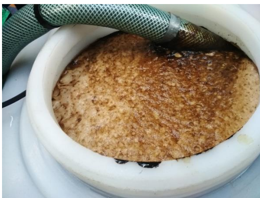
Obr. 41 Ukázka čištění a rozpuštění usazenin ve sběrné nádobě s čistícím prostředkem. Vpravo je ukázka hrubých nečistot zachycených filtrem v čistícím okruhu [10A, 13A].
