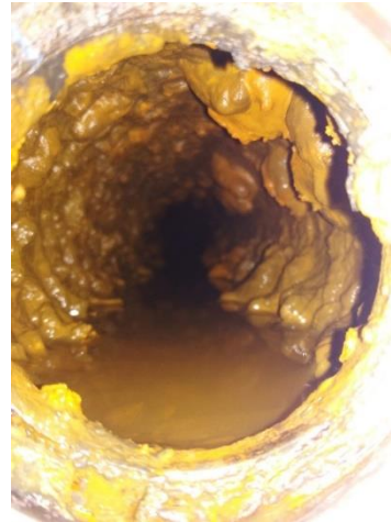
Obr. 40 Obrázek vlevo je ukázka z čištění vnitřních povrchů chlazených válců pro tváření plastu a obrázek vpravo ukazuje zanesení vnitřního povrchu těchto ocelových válců korozi a minerály z neupravené chladicí vody [10A, 13A].
