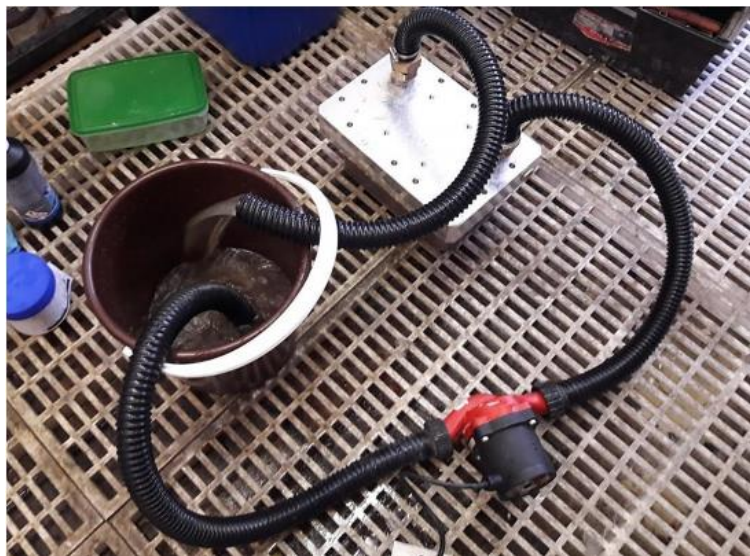
Obr. 59 Ukázka úspěšné zkoušky na těsnost celého čerpacího okruhu s vodou.
