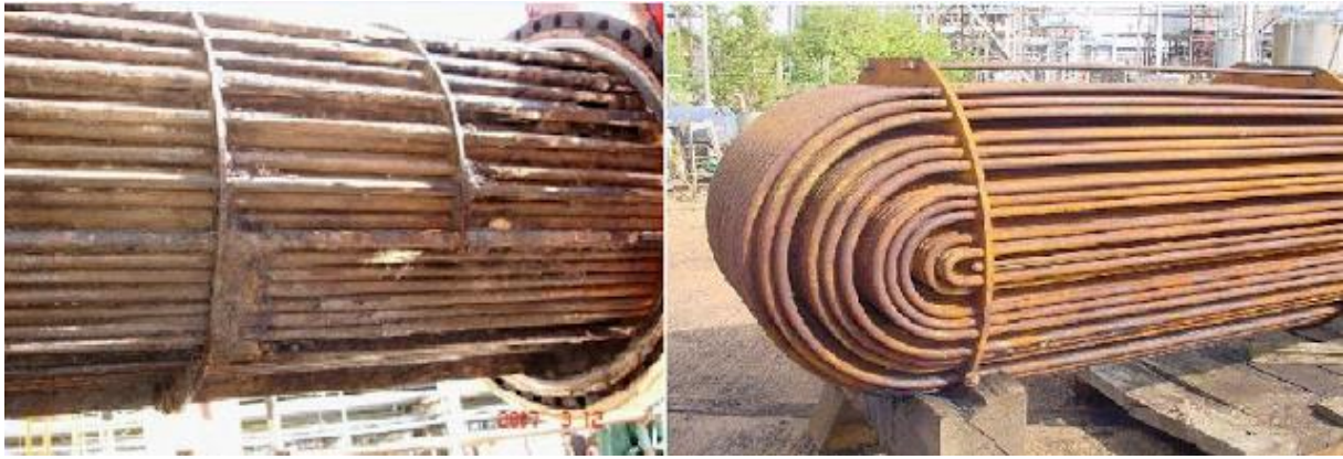
Obr. 8 Příklad korozního zanášení [25].
