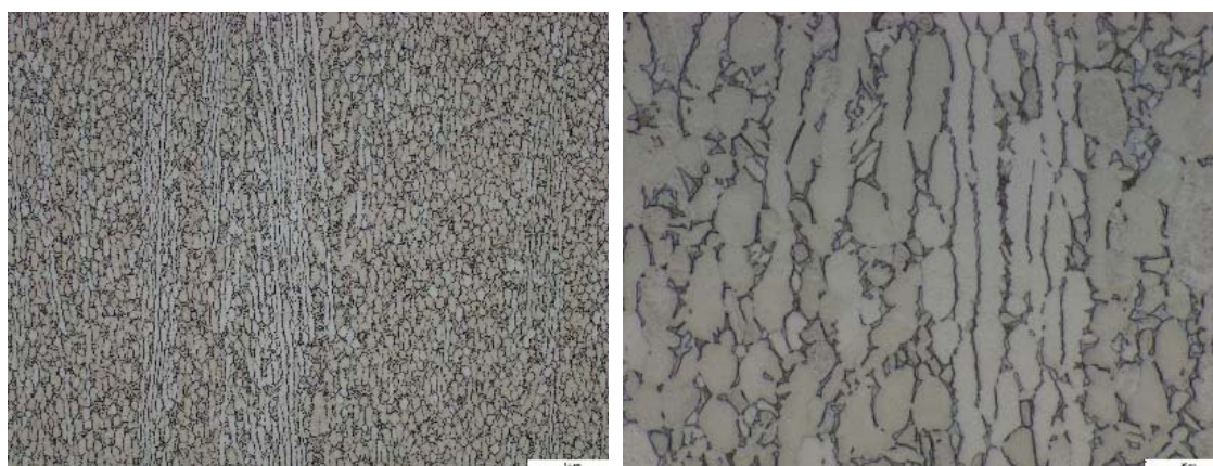
Obr. 11. 10: Příčný řez, titanová slitina Ti6Al4V.
