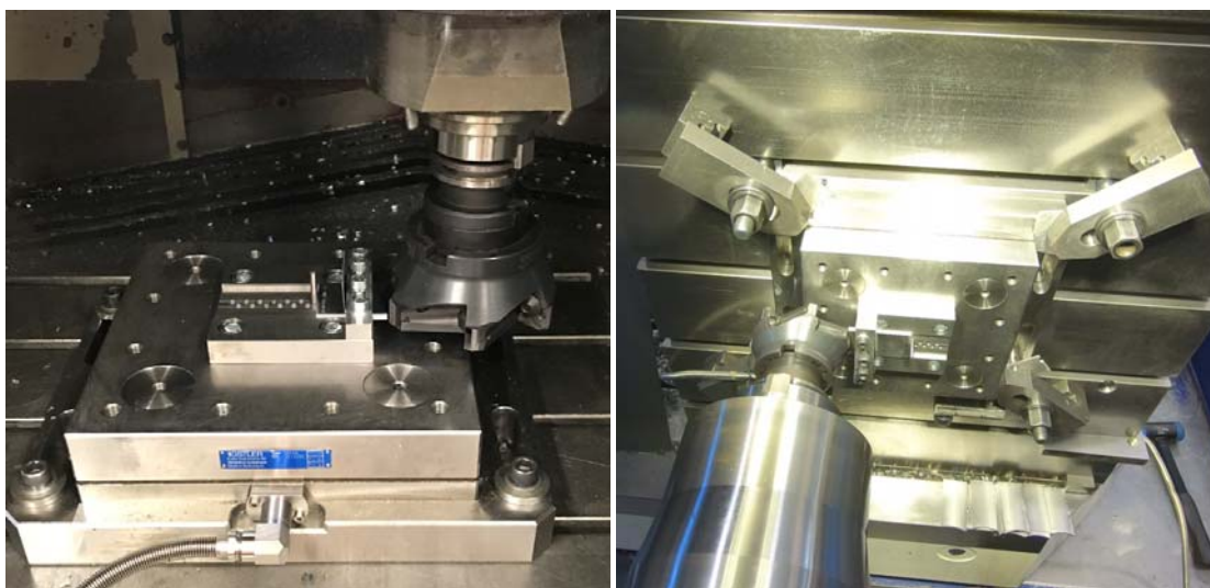
Obr. 32: Realizace experimentů na stroji: obrábění hliníkové slitiny EN AW 7075 na stroji MCFV 5050LN, obrábění oceli DIN C45 na stroji WHN 13 CNC (vpravo).
