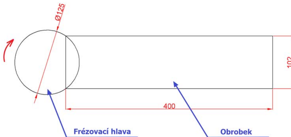
Obr. 70: Obrábění materiálu pro nastavené experimenty.
