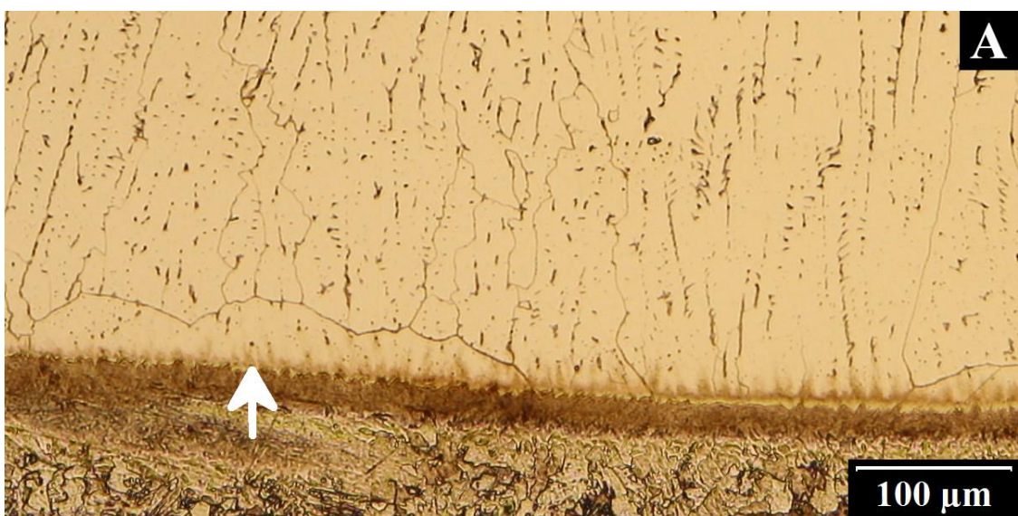
Oblast epitaxiálního růstu zrn na rozhraní ZM-N1 v rámci CELR-1.
