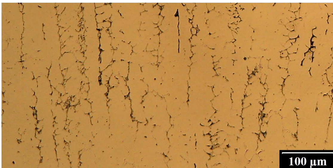
B) Struktura TRR navazující na CELR-2 (poloha 4,3 mm podle Obr. 46).
