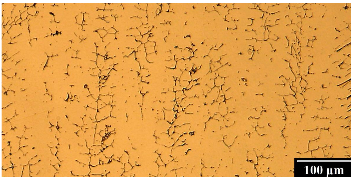
D) Struktura DENR-1 navazující na TRR (poloha: 6,9 mm podle Obr. 36).
