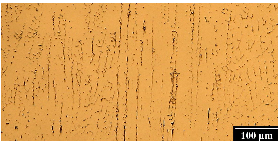
A) Struktura CELR-1 v blízkosti rozhraní se ZM (poloha: 4,5 mm podle Obr. 36).
