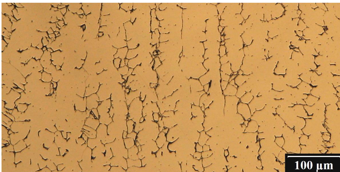
D) Struktura DENR-1 navazující na TRR (poloha: 6,8 mm podle Obr. 23).
