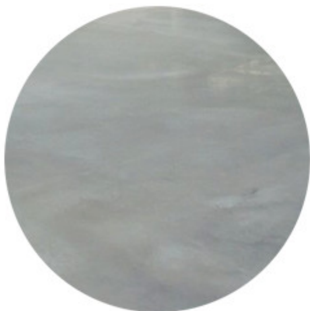
Podlaha - přebroušená, napuštěná drátkobetonová deska
