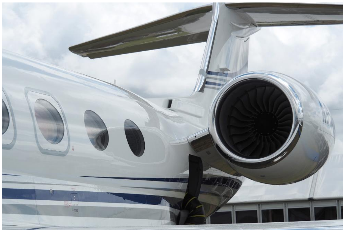
Obrázek 16. Uspořádání motorů u Gulfstream G650 Zdroj: Internet [20]
