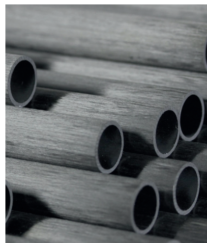
Carbon fiber s podélnou sklatbou vláken
