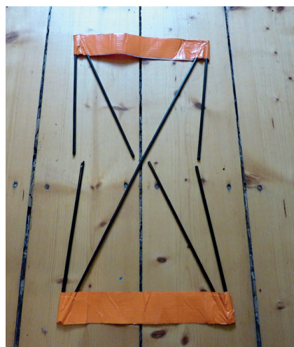
Testovací rám po šestém ohnutí selhal.
