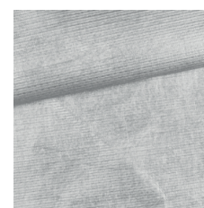
Tyvek softstructure 1443r, 44 g/m 2 - materiál používaný ve stavebnictví (hlavně ve vyšší gramáži) a v chemickém průmyslu na ochranné obleky. V poslední době využíván lidmi ultralight komunity, kteří si z něj sami šijí přístřešky a bivakovací pytle, neboť tento materiál krom nepromokavosti i částečně dýchá (podobně jako trilaminát typu Gore-tex). Vyrábí se pouze v bílé barvě. (40)
