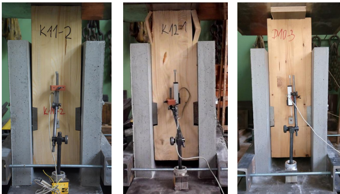
Obr. 38: Vlevo příklad tělesa po porušení usmyknutím trnů, uprostřed příklad tělesa bez podložky po porušení dřeva smykem, usmyknuté ozuby rozepřeny o zatěžovací desku, vpravo příklad tělesa s podložkou na čele trámu umožňující volné usmyknutí ozubu
