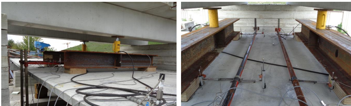
Obr. 77: Vlevo pohled na zatěžovací aparaturu – 2 hydraulické lisy na společném čerpadle rozpřené o železobetonové nosníky, na kterých je umístěna rovnanina ze silničních panelů tvořící balastní zatížení; vpravo měřiče průhybu uprostřed rozpětí
