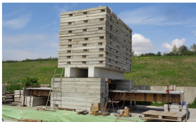
Obr. 75: Schéma zatěžovací zkoušky lávky
