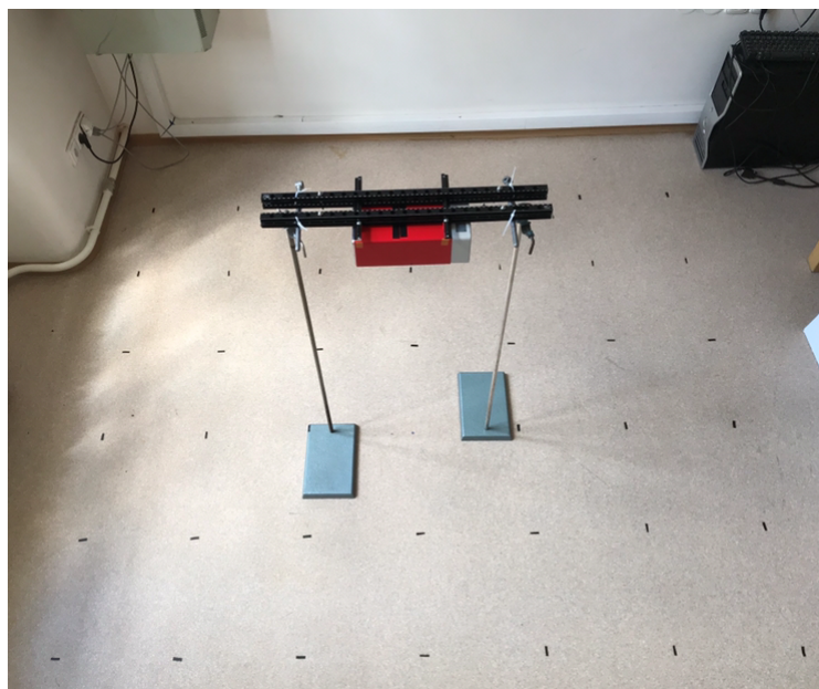
Obrázek 19: Zobrazení aparatury pro měření směrové závislosti a vyznačené sítě
