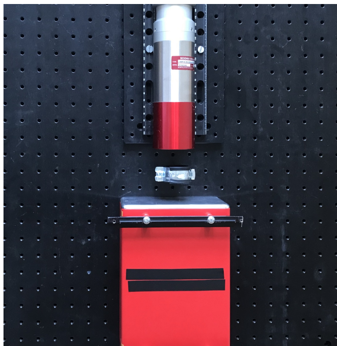
Obrázek 7: Zobrazení geometrie měření energetické kalibrace
