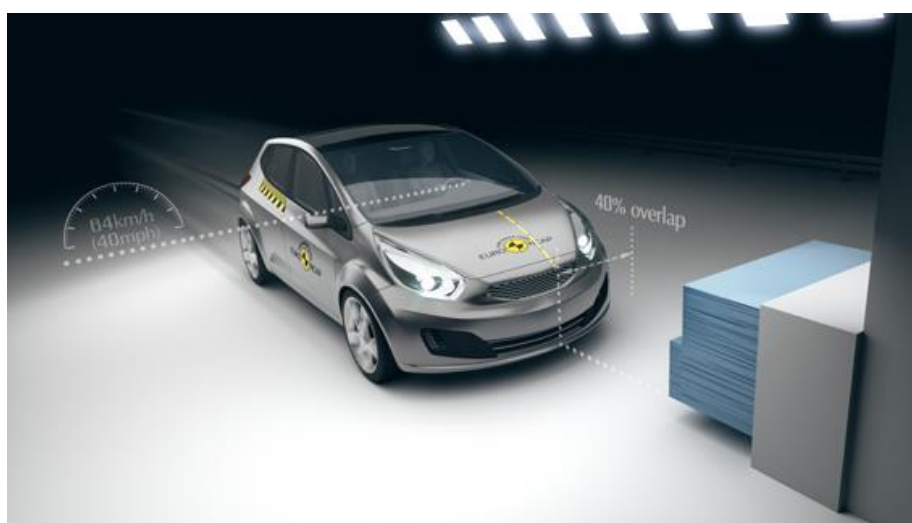
Obrázek 12 - Euro NCAP test částečného překrytí
