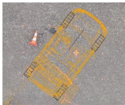
Obrázek 55 - fyzikální 2D model vozidla Toyota Aygo v prostředí programu Virtual CRASH
