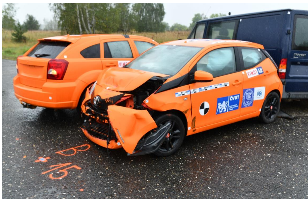
Obrázek 34 - deformace vozidla Toyota Auris po testu 3
