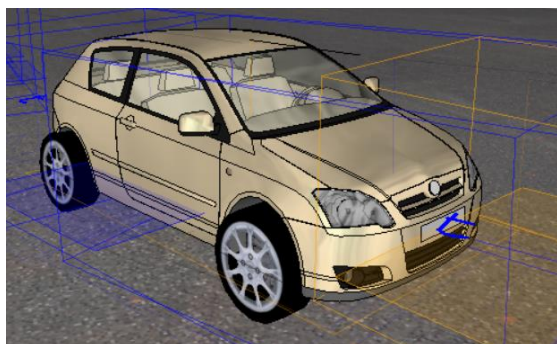
Obrázek 54 – 3D Model Toyoty Corolla nahrazující Toyotu Aygo v prostředí programu Virtual CRASH
