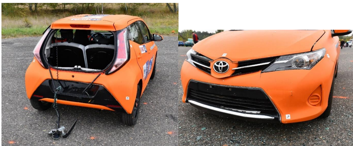
Obrázek 32 – test 2 deformace vozidel Toyota Aygo a Toyota Auris
