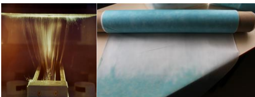
Obr. 30 Zvláknování pomocí zařízení Nanospider TM LB 500; vlevo proces zvláknování, vpravo nanovláknitá textilie na nosném PP spunbondu
