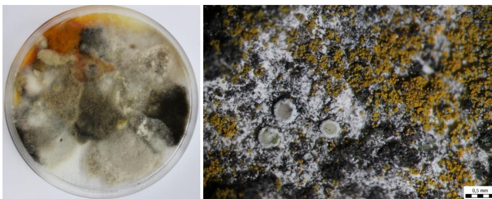
Obr. 27 Vzorek č. 6 z Čelákovic; vlevo po kultivaci, vpravo mikroskopický snímek výřezu omítky s biofilmem
