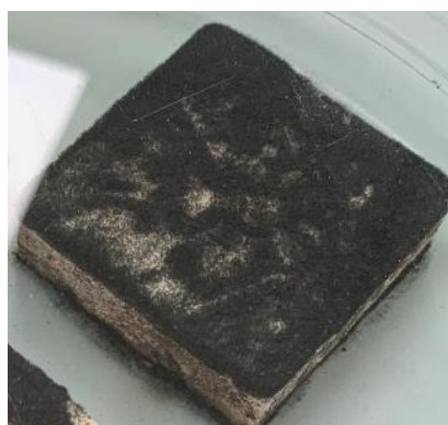
Obr. 60 Fotografie vzorku z konstrukčního sádrokartonu sanovaného aplikací P. oligandrum
