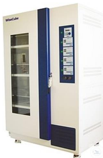
Obr. 55 Velkokapacitní třepací inkubátor pro kultivaci Pythium oligandrum
