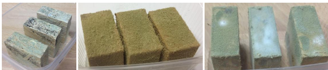
Obr. 22 Vzorky po 30 dnech v RH 97 %; zleva OSB deska 16 mm, dřevovláknno 22 mm, dřevovláknno DHF 15 mm
