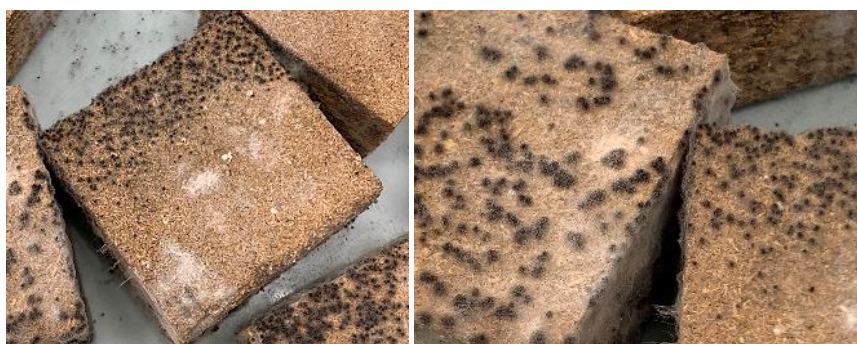
Obr. 59 Fotografie vzorku z dřevovlákná sanovaného aplikací P. oligandrum a detailní pohled
