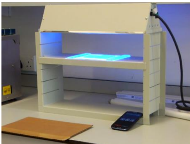
Obr. 39 Soustava pro měření fotokatalytické aktivity nátěrů
