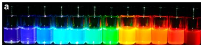
Obr. 2: Koloidní roztoky CsPbX 3 vykazující laditelnou energii šířky zakázaného pásma skrz viditelnou oblast, foceno pod UV lampou 365 nm (Protesescu et al. 2015)
