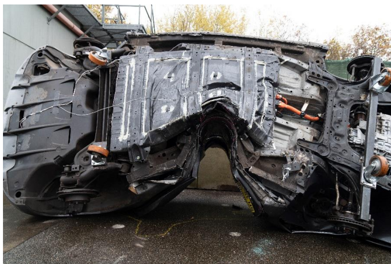
Obrázek 7 – Pohled na zdeformovanou baterii vozu po zkoušce [12]
