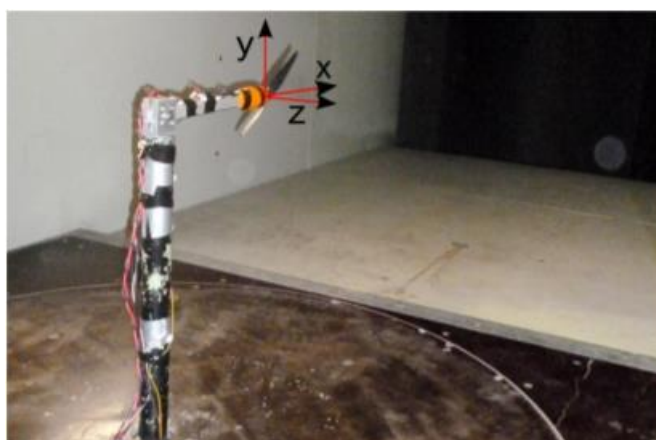
Obrázek 6 – Umístění vrtule Graupner E-prop v prostorách tunelu Liège [14]
