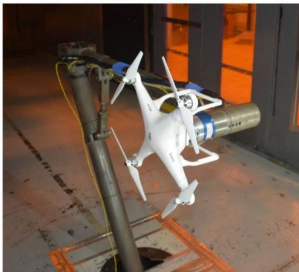
Obrázek 5 – Kvadroptéra DJI Phantom v prostorách aerodynamického tunelu NASA [13]
