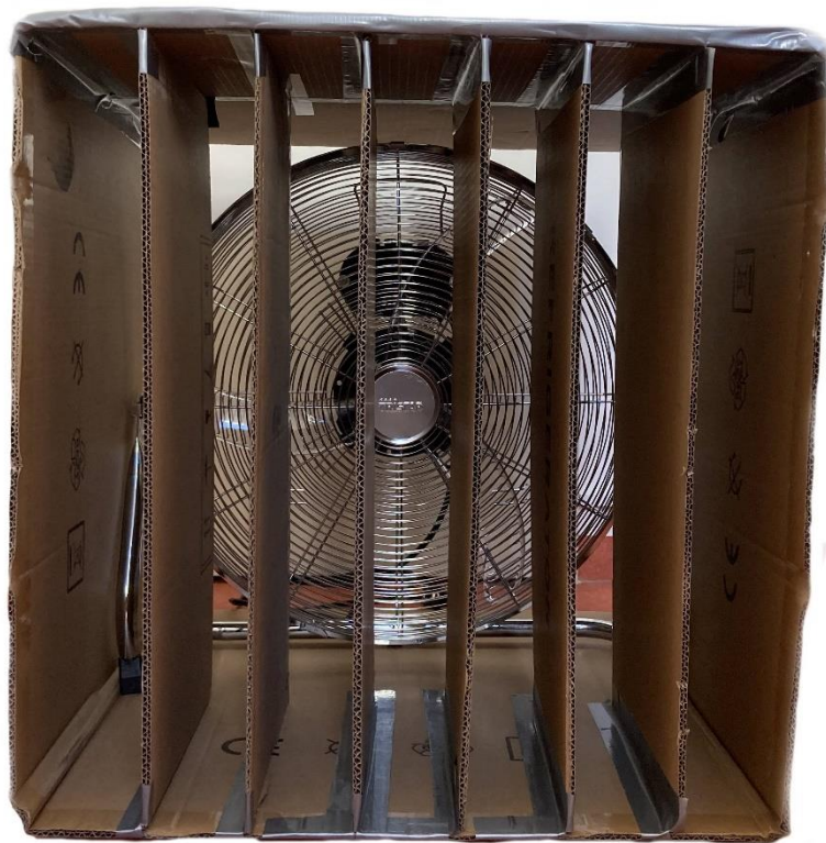
Obrázek 23 – Ventilátor umístěný v laminárním regulátoru
