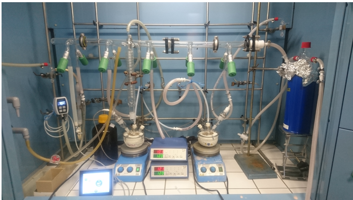
Obr. 3.2: Vakuová linka s připojenými reakčními baňkami v topných hnízdech.
