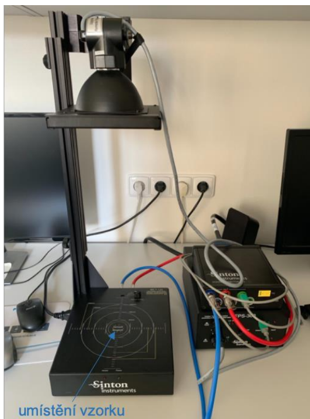
Obr. 10: Přístroj WCT-120 (Sinton instruments) na měření efektivní doby života.
