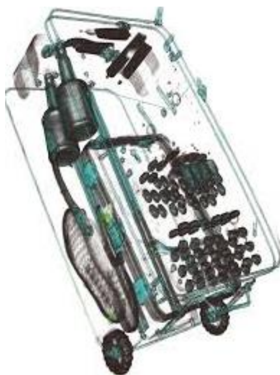
Obrázek 46: snímek z CTX 9800 DSi se zapnutými funkcí pro zvýraznění okrajů předmětů [41]
