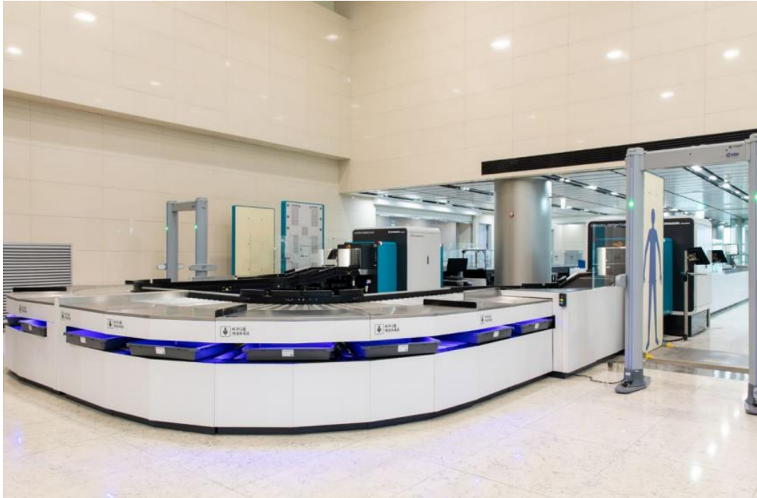
Obrázek 36: model HI-SCAN 6040 CTiX implementován do konceptu automatické tratě na CJU [79]
