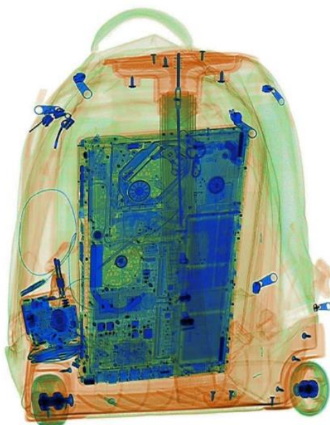
Obrázek 29: Snímek zavazadla s laptopem (dual-energy technologie) [65]
