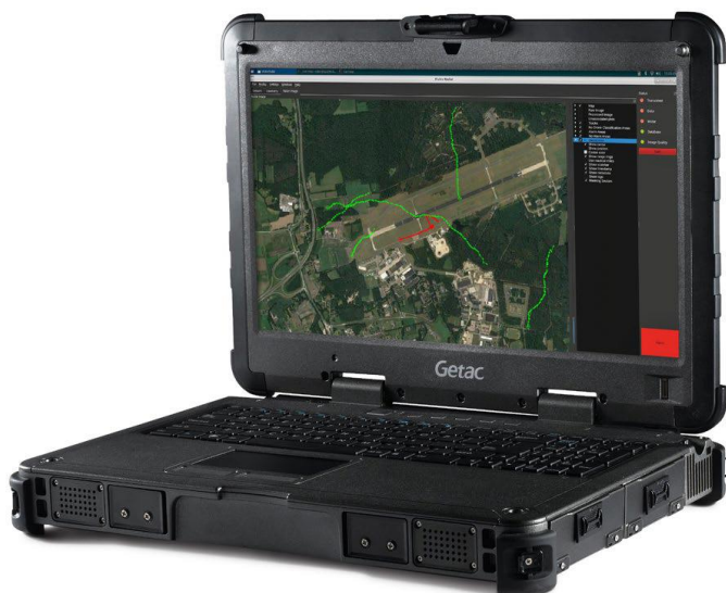
Obrázek 17. Přenosná jednotka se zobrazením výstupu z radaru ELVIRA [41]
