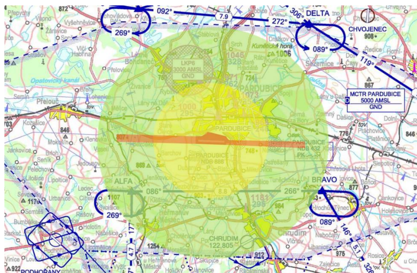
Obrázek 18. Návrh poplašných zón systému AARTOS X9 PRO [28]
