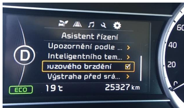
Obrázek 16 - Palubní počítač vozidla Kia Niro značící aktivovaný AEB
