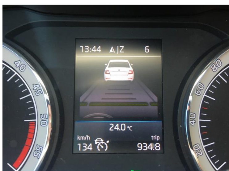
Obrázek 14 - Palubní počítač vozidla Škoda Karoq a nastavení rozestupu od předchozího vozidla na minimální
