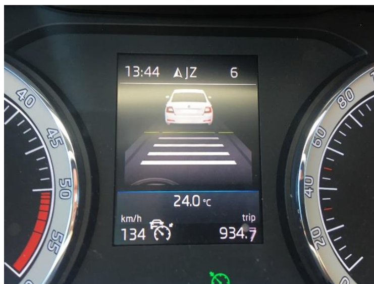
Obrázek 15 - Palubní počítač vozidla Škoda Karoq a nastavení rozestupu od předchozího vozidla na maximální
