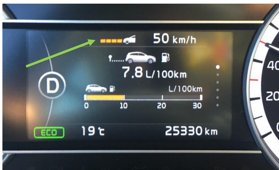
Obrázek 18 - Palubní počítač vozidla Kia Niro; šipka označuje aktuální nastavení rozestupu od předchozího vozidla
