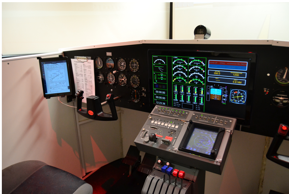
Obrázek 2.2: Prostředí simulátoru včetně přístrojů, navigační dokumentace a checklistu
