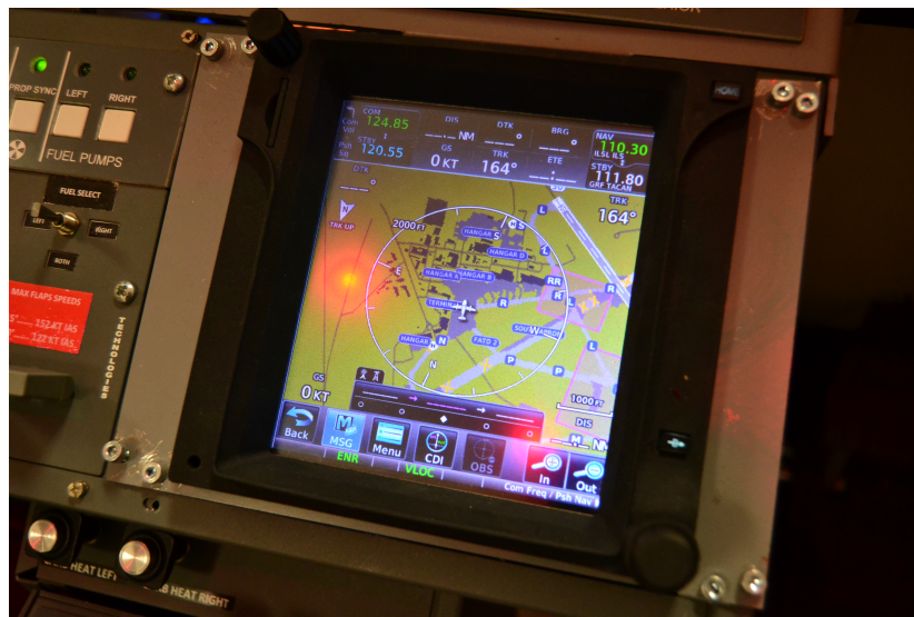
Obrázek 2.1: Modul pro družicovou navigaci simulující Garmin GTN 750
