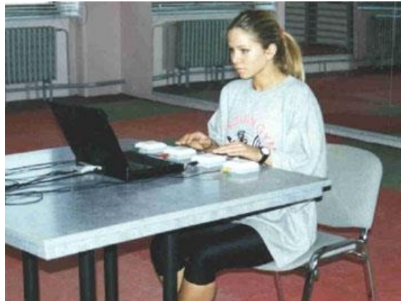
Obrázok 8 - Zariadenie na meranie reakčného času horných končatín Fitro Reaction [21]
