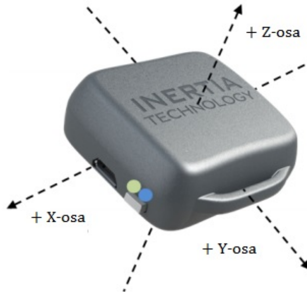
Obrázek 3: ProMove-mini senzor a jeho referenční systém [Zdroj: inertia-technology.com]
